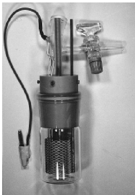
Bild 13: Elektrochemische Zelle für die Impedanzspektroskopie und Zykovoltammetrie an GC-Stab- und Pt-Drahtelektroden; für 80-100 ml Elektrolyt
